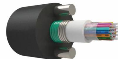
КАБЕЛЬ ОПТИЧЕСКИЙ В КАНАЛИЗАЦИЮ С ЦТ, ПЕРИФЕРИЙНЫЕ СИЛОВЫЕ ЭЛЕМЕНТЫ СТАЛЬНАЯ ПРОВОЛКА, БРОНИРОВАННЫЙ СТАЛЬНОЙ ЛЕНТОЙ
